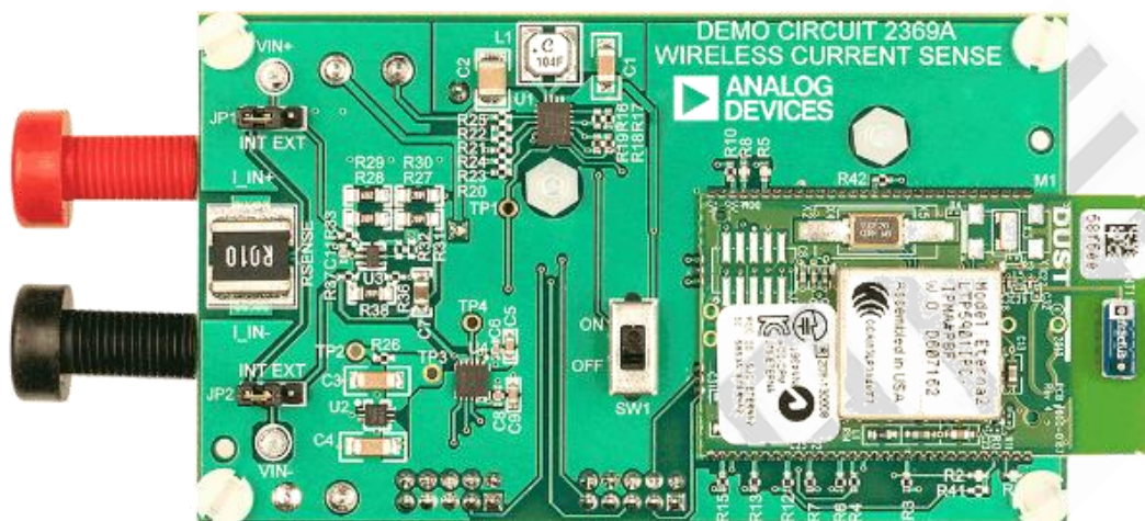
图 3. 在小型 PCB 上实现的一个完整无线电流检测电路。唯一的物理连接是待测电流的香蕉插座。无线电模块如右图所示。电路由连接到板背面的两节 AAA 电池供电。
